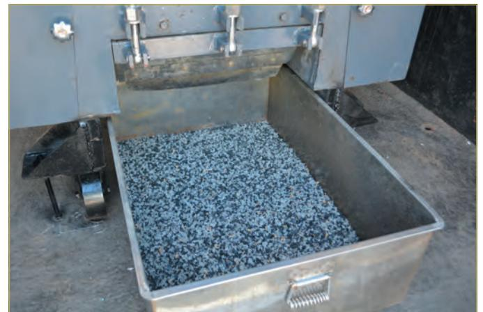
Рис. 3. Переработанная из пластика крошка в грузовике Eco Truck
