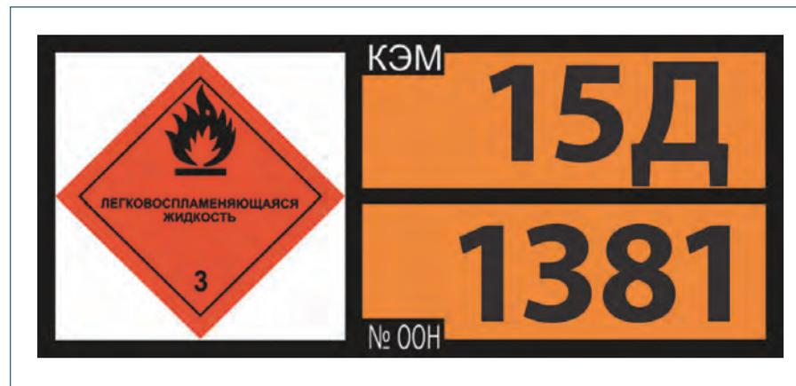
Рис. 2. Информационная табличка транспортного средства, перевозящего опасный груз
