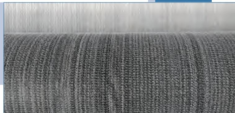
**Б**ентонитовый мат **Isobent** представляет собой гидроизоляционную мембрану для подземной гидроизоляции. Материал использует свойство бентонита образовывать водонепроницаемый слой, увеличивая многократно свой объем при контакте с водой. **Isobent** производится как трехпластовый сэндвич – гранулированный бентонит помещается между двумя слоями геотекстиля.
