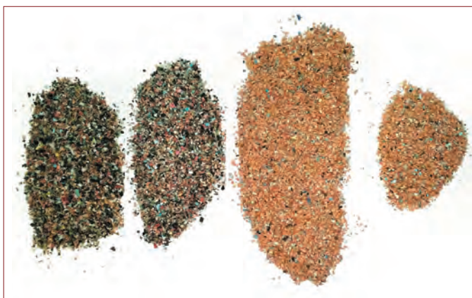
Рис. 3. Разделенная смесь полимеров на трибоэлектростатическом сепараторе: ПВХ (слева), ПВД (справа)
