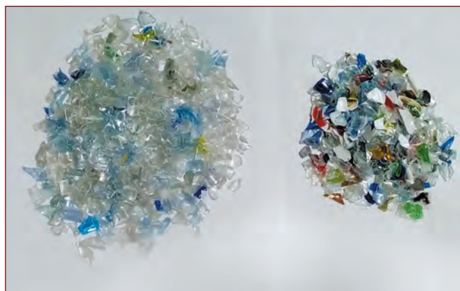
Рис. 4. Разделенная смесь полимеров на трибоэлектростатическом сепараторе: ПЭТ (справа), ПВХ (слева)
