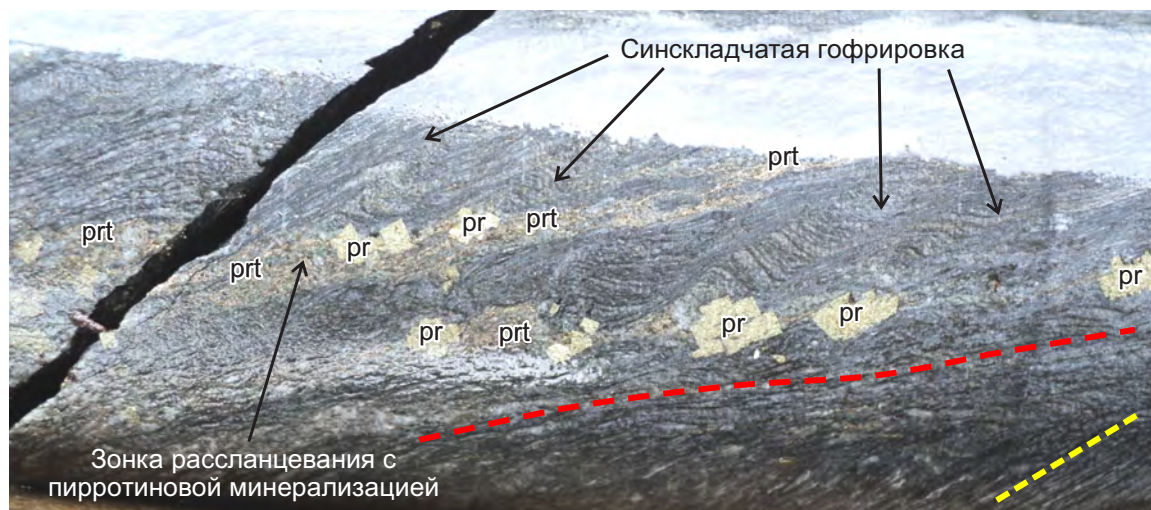
Рис. 21. «Срезание» синскладчатой гофрировки и сланцеватости (жёлтый пунктир) сланцеватостью (красный пунктир) и зонками рассланцевания с пирротитовой минерализацией (prt). Более позднее образование «кубического» пирита (pr) относительно пирротитана. Скв. 1. Диаметр керна 63 мм
