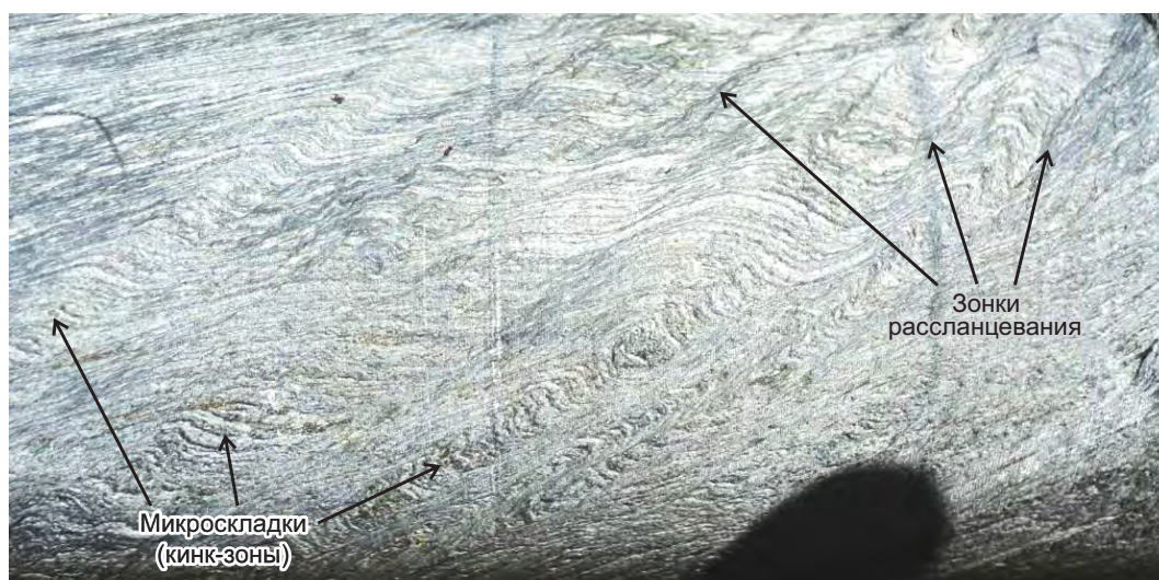
Рис. 15. Микроскладчатая (типа кинк-зон) деформация тонкопереслаивающихся углеродистых сланцев (тёмные слойки) и алевросланцев и алевропесчаников (светлые слойки) – начальный этап формирования зон рассланцевания. Сква. 4, 175 м. Диаметр керна 63 мм
