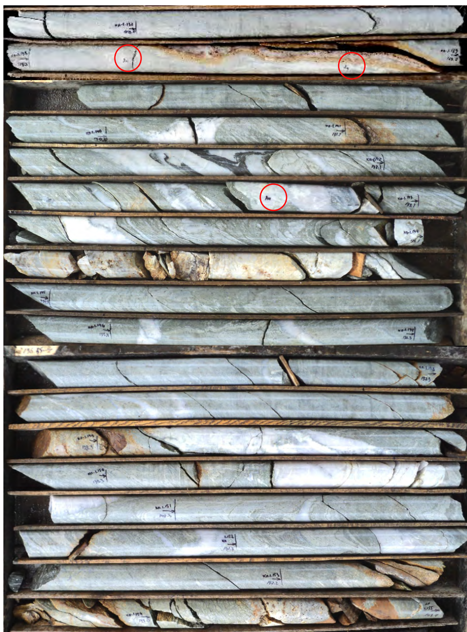
Рис. 23. Строение центральной части рудной зоны № 1. Красными кружками показаны участки с видимым золотом. Светлое – кварцевые, анкерит-кварцевые и альбит-кварцевые жилы. Вмещающие породы – пирит-анкерит-мусковит-кварцевые, пирит-мусковит-кварц-анкеритовые, пирит-кварц-анкерит-мусковитовые метасоматиты. Скв. 1, 128,0–143,7 м. Диаметр керна 63 мм
