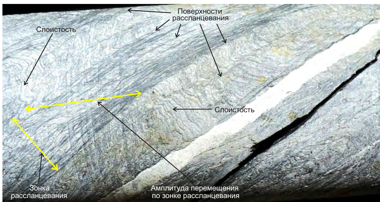
Рис. 12. Полная переработка слоистости тонкопереслаивающихся углеродистых сланцев (тёмные слойки) и алевросланцев и алевропесчаников (светлые слойки) в зоне расщепления (обозначена жёлтой стрелкой). Скв. 4, 176 м. Диаметр керна 63 мм
