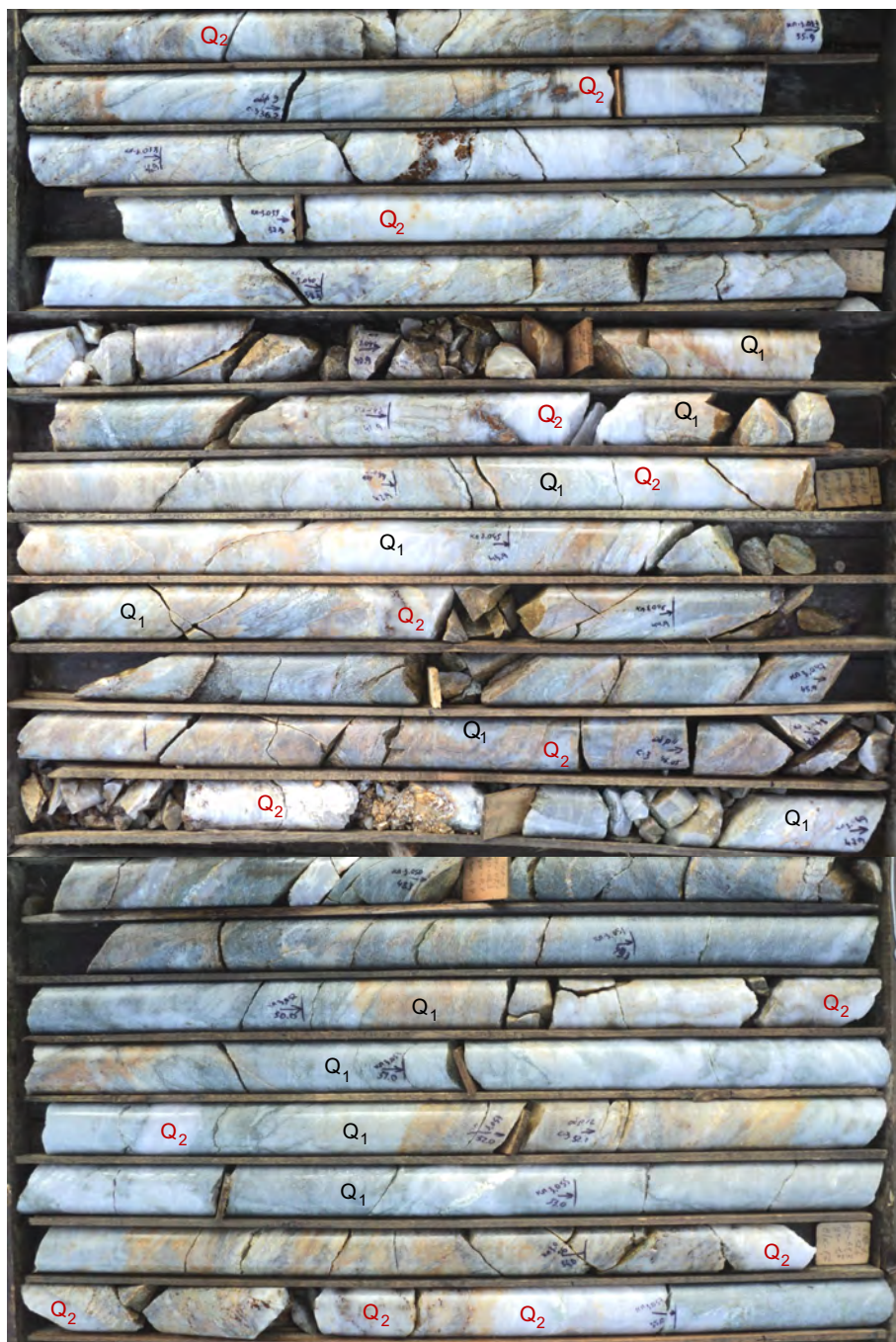
Рис. 27. Строение центральной части рудной зоны № 2. Гидротермально-метасоматические ( Q_1 ) жилы и прожилки, субсогласные сланцеватости метасоматитов, и секущие их пирит-альбит-анкерит-кварцевые ( Q_2 ) жилы в кварц-анкерит-мусковитовых метасоматитах. Скв. 3, 35,0–54,5 м. Диаметр керна 63 мм
