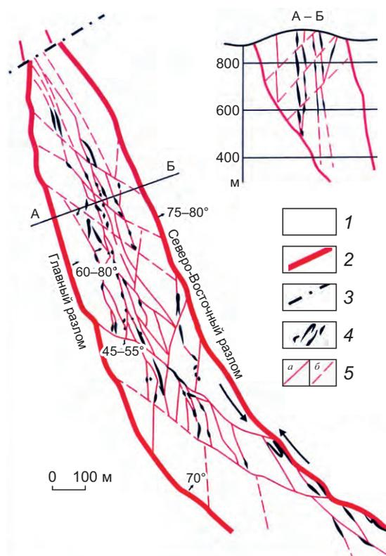
**Рис. 1. ГЕОЛОГО-СТРУКТУРНАЯ СХЕМА НАТАЛКИНСКОГО МЕСТОРОЖДЕНИЯ (северная и центральная части), ПОПЕРЕЧНЫЙ РАЗРЕЗ С ПУЧКОМ РУДОНОСНЫХ ОПЕРЯЮЩИХ СКОЛОВ И РУДНЫХ ТЕЛ, ОТДЕЛЯЮЩИХСЯ ОТ МАГИСТРАЛЬНЫХ ШВОВ ГЛАВНОГО РАЗЛОМА, ПО [10]:**
