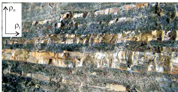
Рис. 1. Анизотропная горная порода
