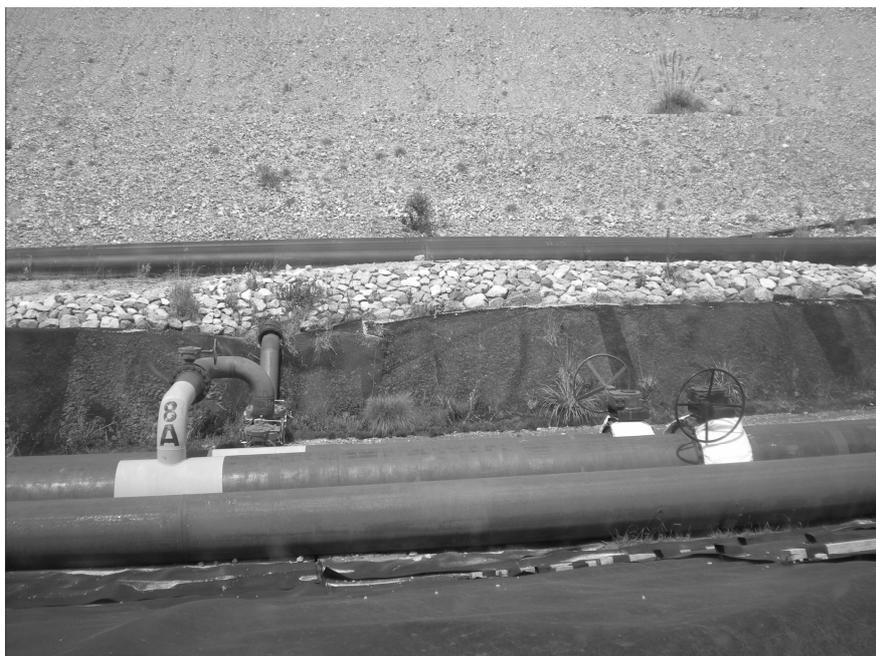
Рис. 4. Стальные нагнетательные трубы для подачи свежего раствора на штабель и пластиковая труба для отвода нагруженного раствора самотеком
