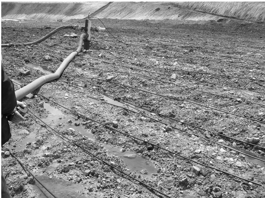
**Рис. 6. Система распределения свежего раствора:**
