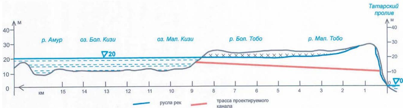
**Рис. 1. Схематический разрез по трассе планируемого канала (дренажного русла): «русло Амура — озеро Большое Кизи — озеро Малое Кизи»**
