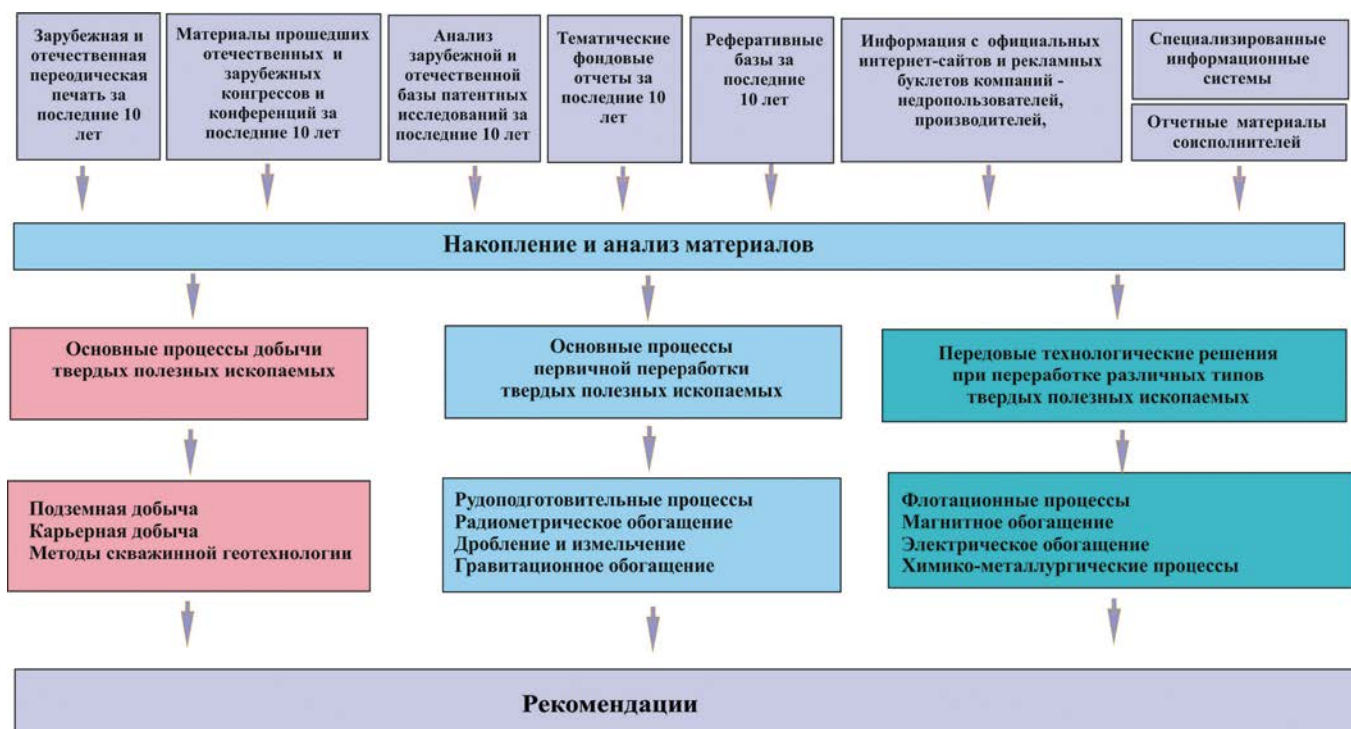
Рис. 3. Блок-схема методического подхода к технологической оценке минерального сырья
