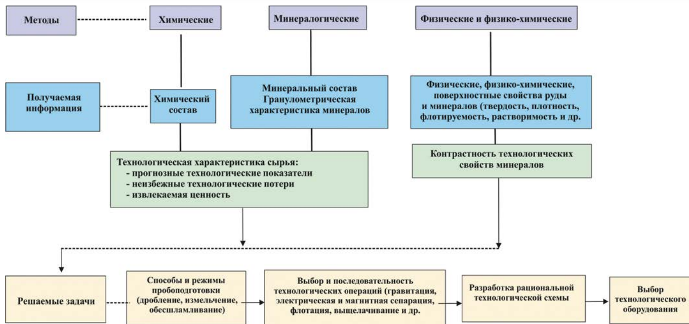
Рис. 4. Алгоритм исследования технологических свойств минерального сырья для выбора оптимальной схемы переработки
