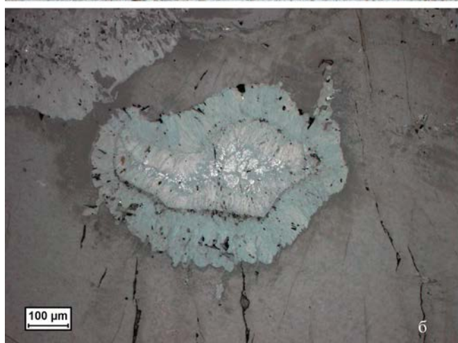
Рис. 1. Реакционные каймы на границе плагиоклаза и оливина: а — проходящий свет, николи параллельны; б — проходящий свет, николи скрещены
