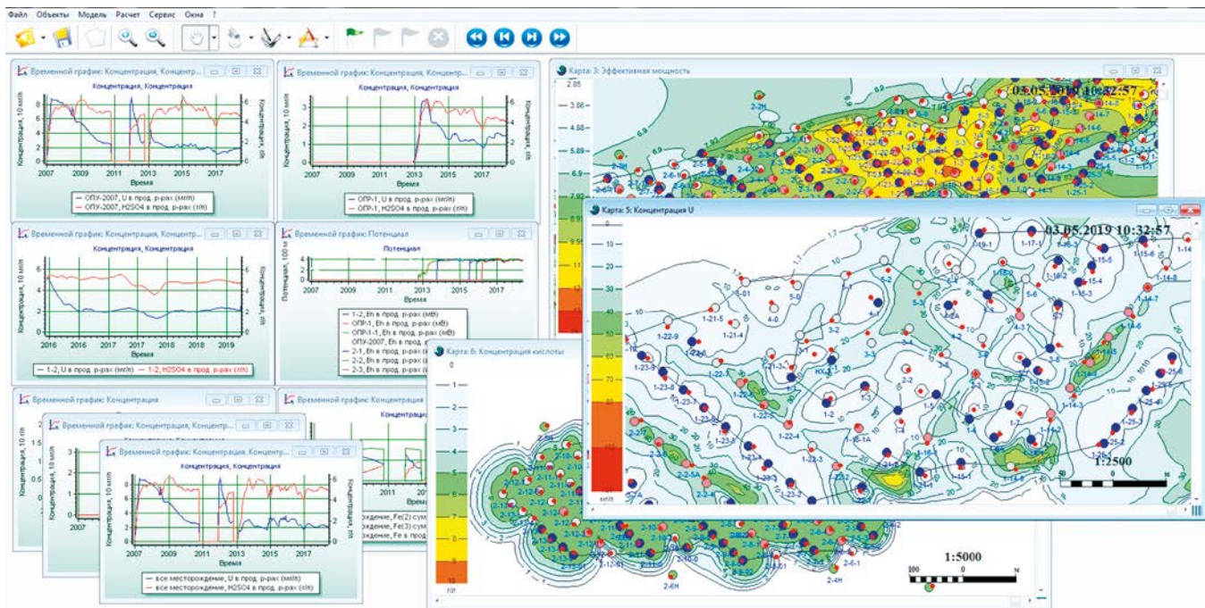
Рис. 1. Рабочее окно программного обеспечения для прогнозирования миграции загрязняющих веществ и оценки воздействия на окружающую среду в результате добычи урана методом СПВ
