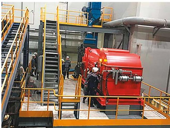
**Рис. 10. Сепаратор Tertiary XRT 1200/D на обогатительной фабрике трубки им. В. Гриба**
