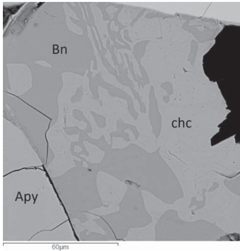
Рис. 5. Структура распада твердого раствора борнита (Bn) и халькозина (chc) между зернами арсенипирита (Apy). Изображение в обратно рассеянных электронах
