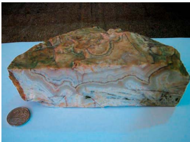
Рис. 6. Кварц-адуляровая руда колломорфно-полосчатой текстуры
