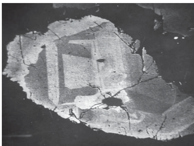
Рис. 7. Фотография в отраженных электронах кристалла эвдиалита из рудного эвдиалита, состоящего из мелких, частично поломанных кристаллов эвдиалита (увеличение \times 20 )
