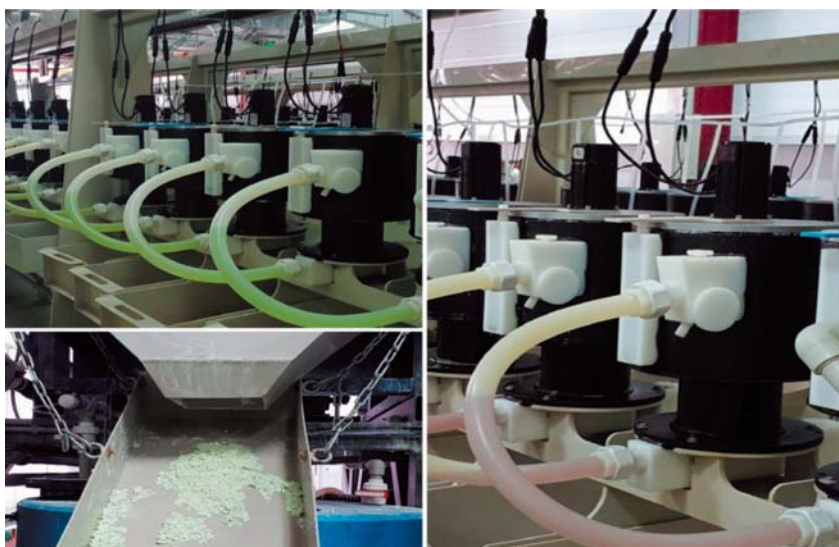
Рис. 5. Фрагменты участка получения оксидов неодима и празеодима, модель экстрактора-ЭЦ-1000ПБ
