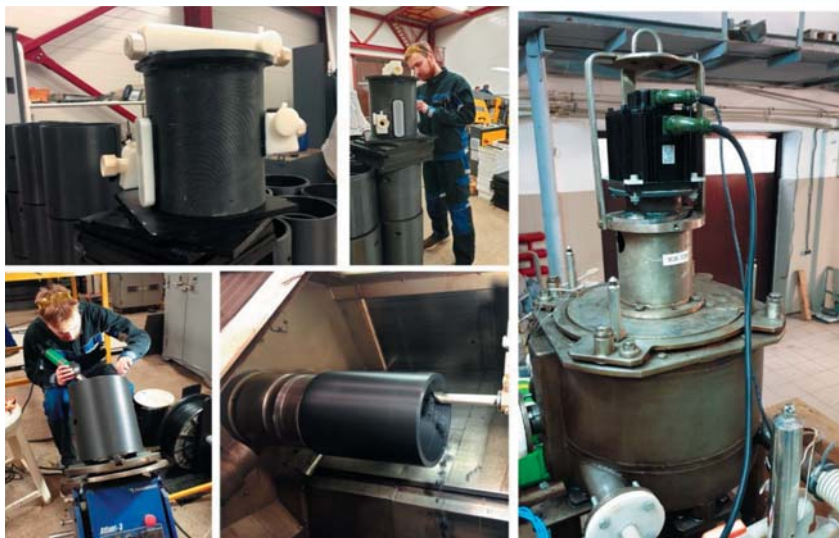
Рис. 4. Фрагменты производства центробежных экстракторов в ООО «ЛИТ»
