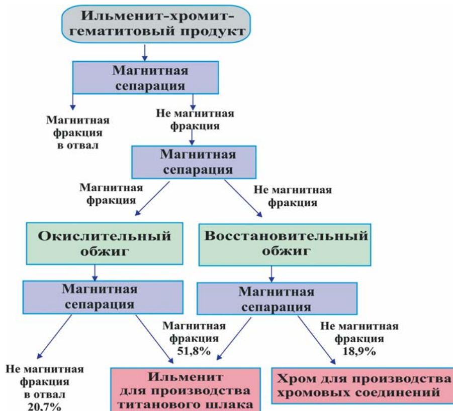
Рис. 4. Принципиальная блок-схема процесса переработки ИХГ-продукта Лукояновского месторождения [2]
