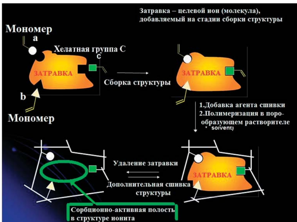
Рис. 1. Блок-схема синтеза ионитов молекулярного распознавания с формированием матричной полости с сорбционно-активными группами (чаще всего хелатного действия). Форма полости в точности повторяет пространственную конфигурацию целевого иона (молекулы) [1]
