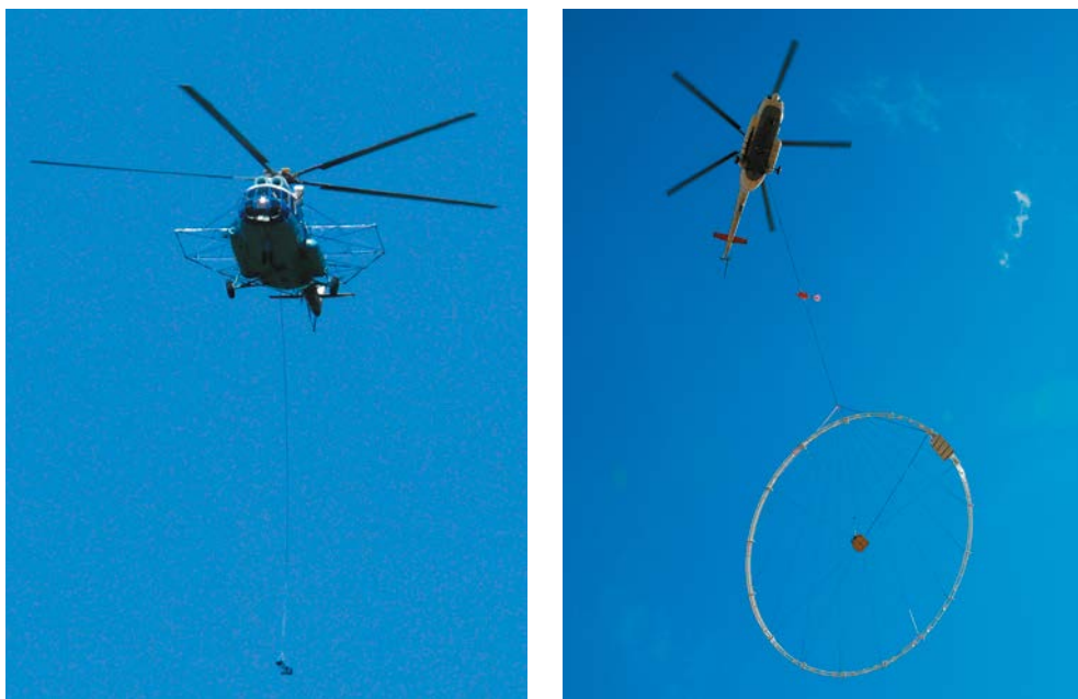
Рис. 4. Электроразведочный комплекс EM-4H (слева) и Time Domain (справа) на вертолете Ми-8
