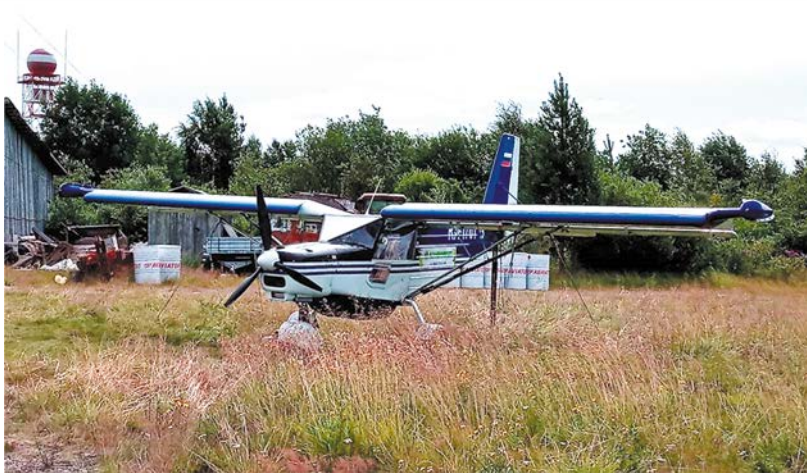
Рис. 1. Легкий самолет СП-30, оборудованный для аэромагнитной съемки. Два датчика магнитометра расположены на концах крыльев. Справа — тот же самолет в сложенном виде для транспортировки в прицепе к легковому автомобилю
