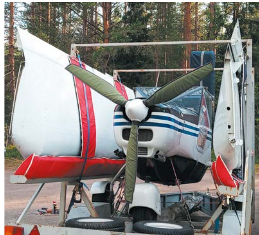
Рис. 1. Легкий самолет СП-30, оборудованный для аэромагнитной съемки. Два датчика магнитометра расположены на концах крыльев. Справа — тот же самолет в сложенном виде для транспортировки в прицепе к легковому автомобилю
