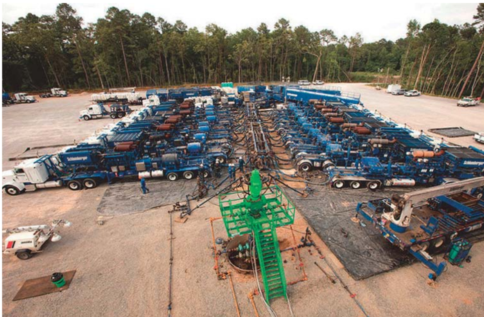
Рис. 3. Добыча углеводородов в США методом гидроразрыва. Техника и необходимое оборудование
