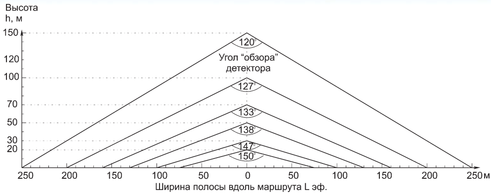
Рис. 3. Схема расчета угла «обзора» спектрометра в зависимости от высоты полета (по данным Л.Н. Вавилина, 1982)
