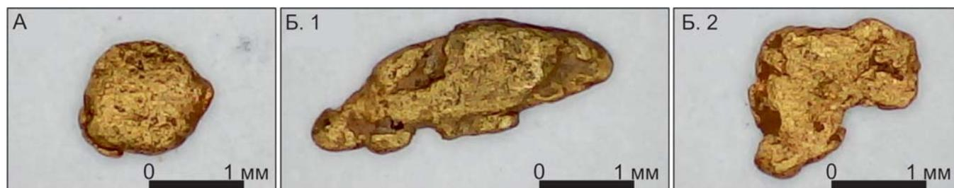
**Рис. 4. Различные типы золотин техногенных образований руч. Куранах по форме.** Класс крупности  $-2,5+1,25$  мм: А — золото хорошо окатанное округлой и овальной формы; Б.1, Б.2 — золото комковидное, относительно простой формы с округлыми краями
