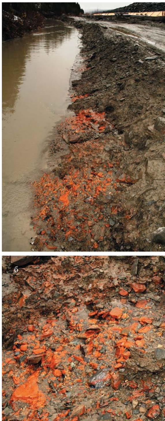
Рис. 3. Выход фильтрата кислых железисто-сульфатных техногенных вод из хвостохранилища Советской ЗИФ
