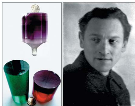
Рис. 8. Шамовский Лев Матвеевич в 1930-е годы: слева — булы флюорита, выращенные в его лаборатории с примесью U^{4+} , Sm^{2+} , Eu^{2+} в 1970-е годы
