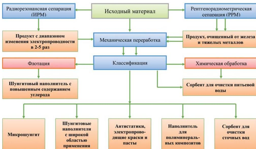
Схема комплексной переработки шунгитового сырья, разработанная в ВИМСе
