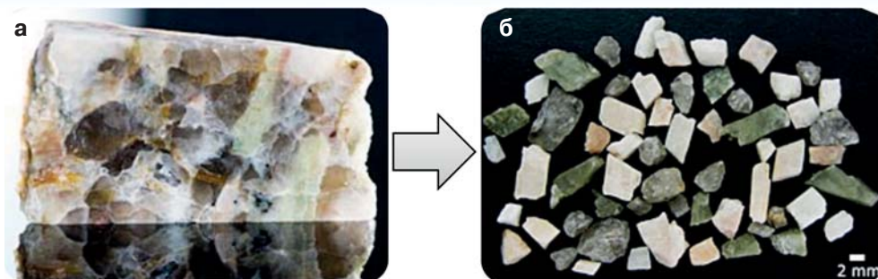
Рис. 5. Продукт электродинамической фрагментации литиевого пегматита (данные ANZAPLAN [6]): а — полированная часть литиевого пегматита; б — разделенные пегматитовые минералы
