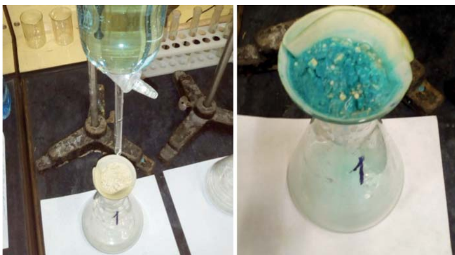
Рис. 2. Схема эксперимента, имитирующего контакт водного раствора медного купороса с твердым карбонатом кальция
