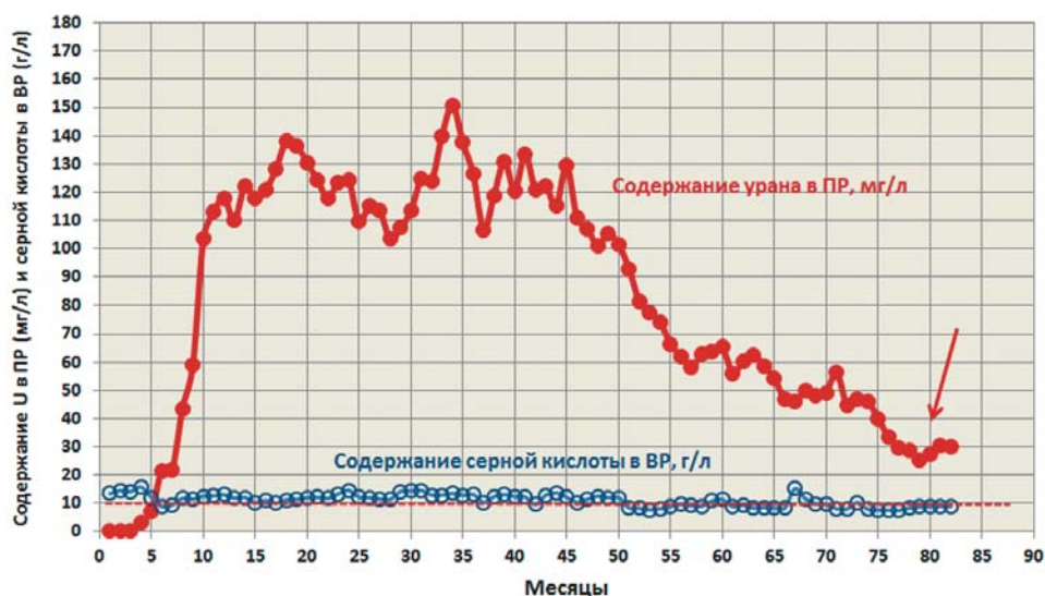
Рис. 1. График отработки рудной залежи Х6 Хиагдинского месторождения. Красная пунктирная линия — минимальное промышленное содержание урана в ПР
