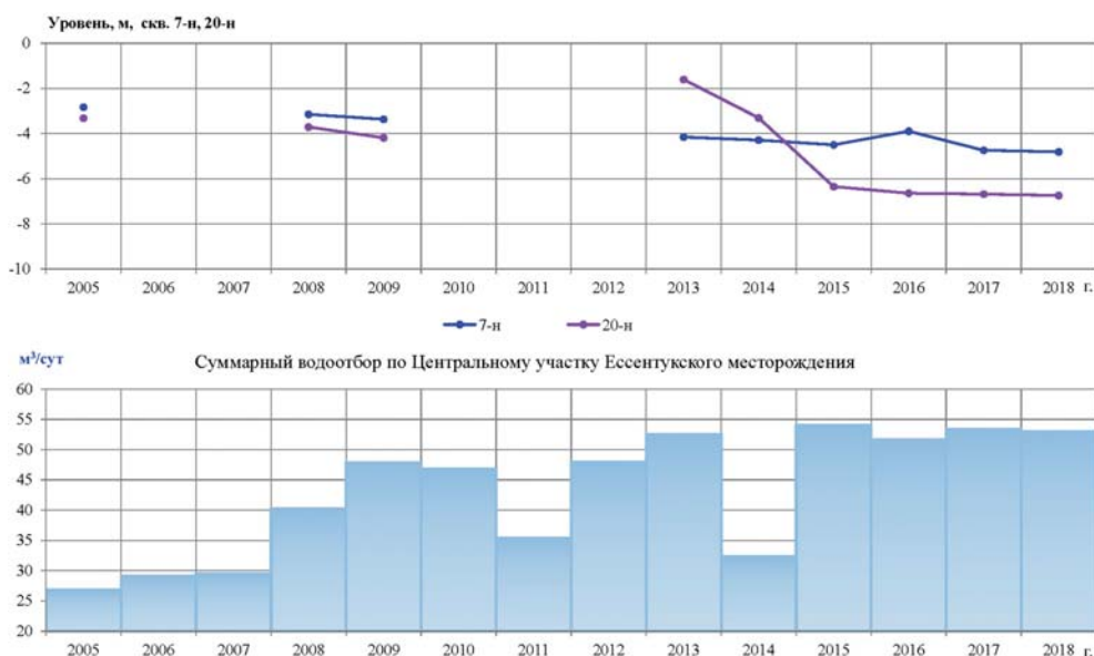
Рис. 4. График изменения уровней в наблюдательных скважинах Центрального участка Ессентукского месторождения (палеоценовый водоносный горизонт)
