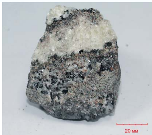
Рис. 1. Текстура руды АЗ Ковдорского месторождения — вкрапления магнетита (черное) и слюды (бурое) среди зерен карбоната (светлое)
