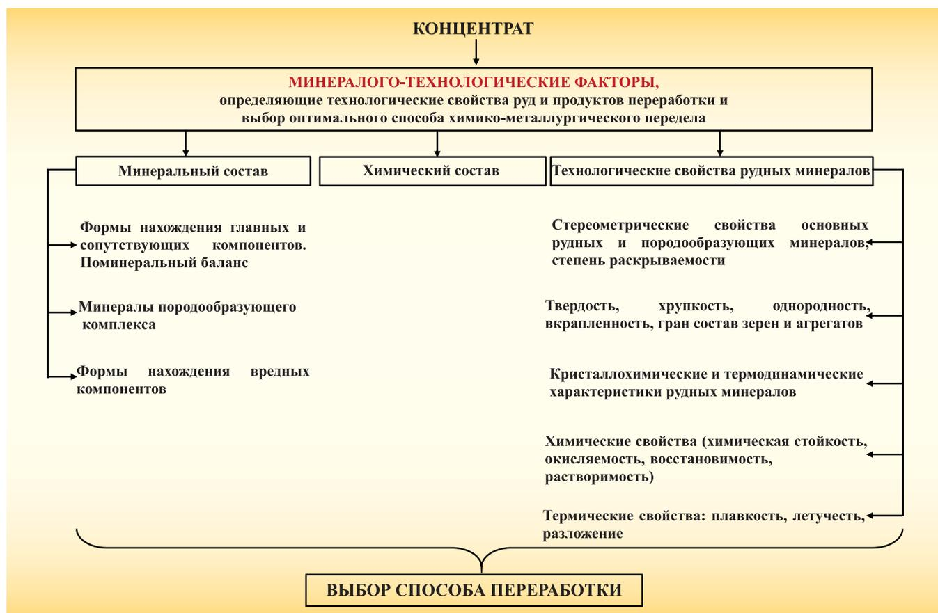
Рис. 1. Минералого-технологические факторы, определяющие выбор способа переработки минерального сырья
