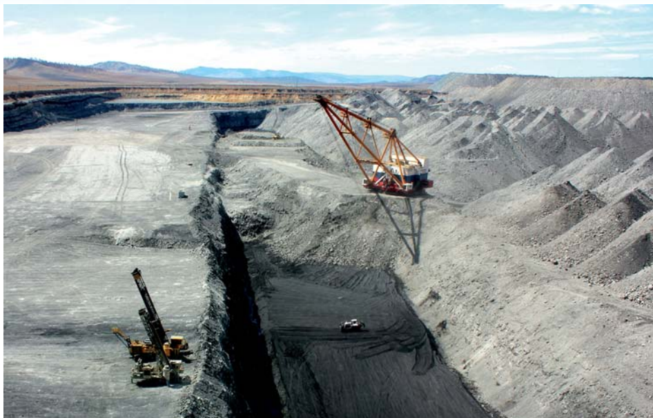
Рис. 1. Процесс вскрытия угольного пласта шагающим экскаватором и подготовка его к выемке
