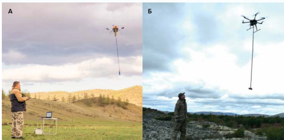
Рис. 3. Магниторазведочные БПЛА: А — ИНГГ СО РАН, Новосибирск (по материалам семинара им. Вахромеева, [2]); Б — из состава комплекса SibGIS UAS, Иркутск
