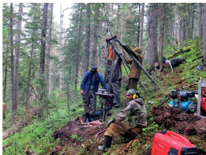
Рис. 3. Подготовка площадки для комплекса МБУ на склоне с уклоном 20°
