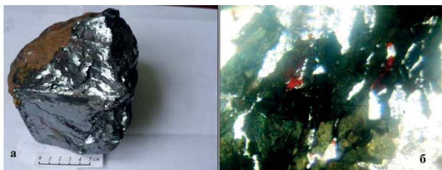
Рис. 3. Кутимское проявление минеральных пигментов: а — крупнопластинчатая разновидность железного блеска; б — пластинчатые кристаллы железного блеска
