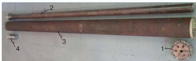
Рис. 2. Гидроустройство с возобновляемым, забойным источником энергии со сплошным забоем бурения скважин: 1 — составное долото; 2 — шпindelь; 3 — наружная труба; 4 — переходник
