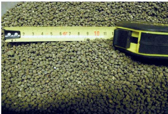
Общий вид рудных гранул, поступающих на выщелачивание
