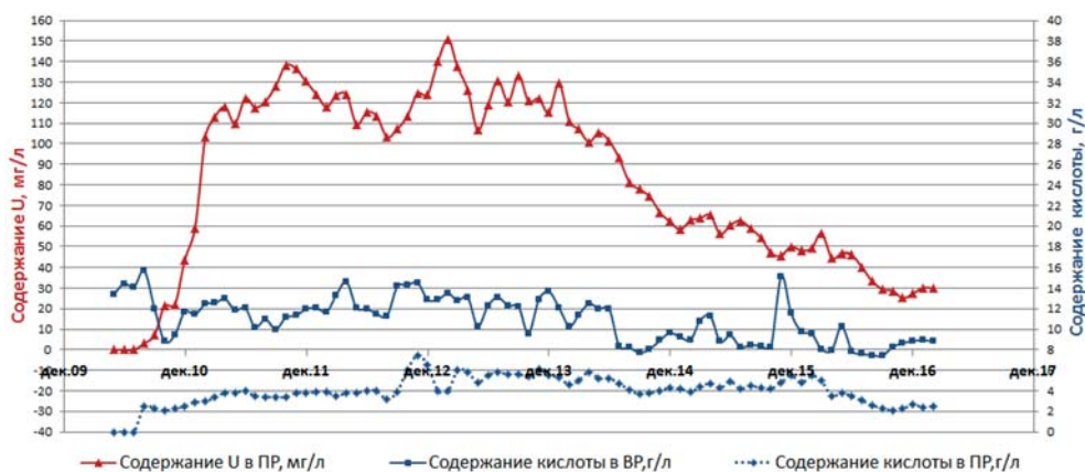
Рис. 2. Результаты отработки ураново-рудной Залежи Х6 до уровня извлечения 78 % на 01.01.2017. Сокращения: ВР — выщелачивающий раствор; ПР — продуктивный раствор
