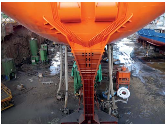
Рис. 1. Ледовая защита, смонтированная на корме НИС «Академик Федоров»
