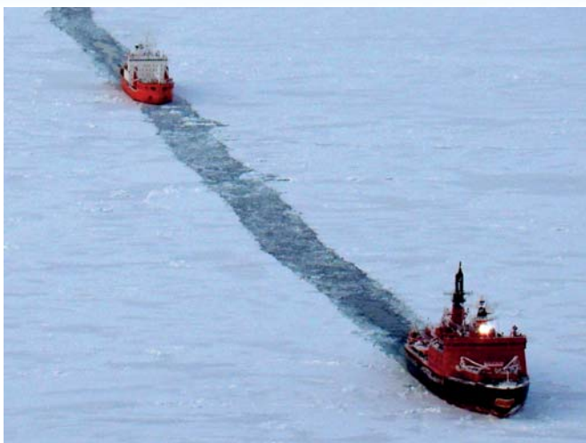
Рис. 3. Технология отработки профиля в сплошных ледовых полях
