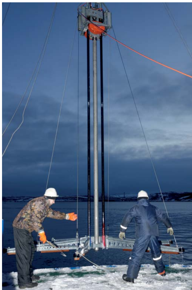
Рис. 1. Вибрационный пробоотборник GEO-VIBRO CORER 3000+6000
