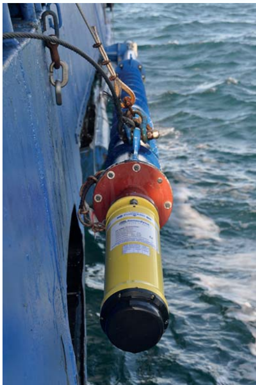
Рис. 1. Антенна акустической системы позиционирования
