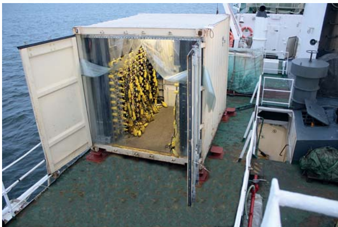
Рис. 2. Размещение терминала донных регистраторов ОВХ на борту судна
