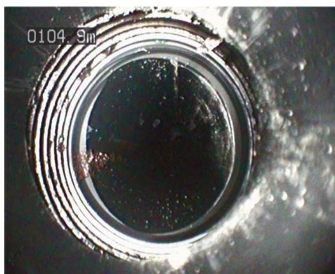
**Рис. 3. Раскрученное резьбовое соединение на глубине 104,5 м, зафиксированное методом фотокариртажа**
