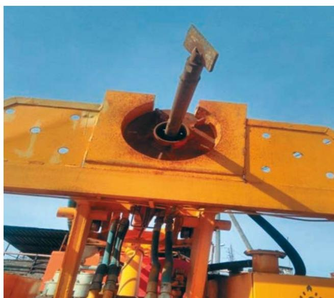
**Рис. 4. Инструмент для довинчивания ослабленных резьбовых соединений**
