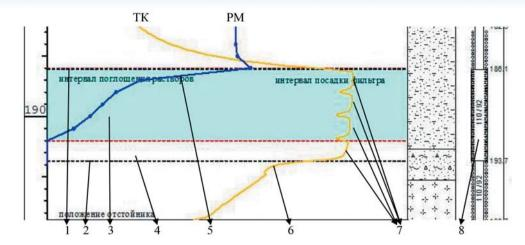
Рис. 2. Результаты расходометрии в закачной скважине: 1 — верхняя граница фильтра; 2 — нижняя граница фильтра; 3 — рабочий интервал фильтра; 4 — неработающий интервал фильтра; 5 — график расходометрии; 6 — график токового каротажа; 7 — секции фильтра; 8 — фильтр (интервал установки 186,1–193,7 м)
