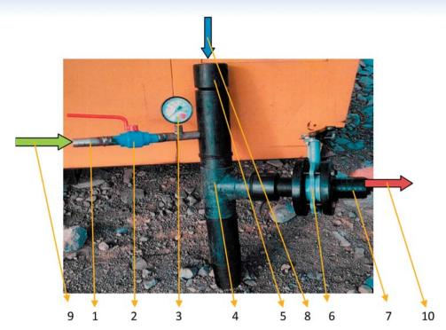
Рис. 5. Универсальный пневмосваб: 1 — штуцер подсоединения шланга подачи выщелачивающего раствора; 2 — кран; 3 — манометр; 4 — корпус пневмосваба; 5 — узел ввода воздухоподающего шланга; 6 — затвор; 7 — штуцер подсоединения сбросного шланга; 8 — подача сжатого воздуха по воздухоподающему шлангу; 9 — подача выщелачивающих растворов; 10 — отвод откачиваемой жидкости
