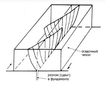
Рис. 2. Диагональные сдвиги Риделя, не имеющие взбросовой компоненты смещения в трехмерном измерении [17]: Простирание риделей по отношению к трассе разлома указывает на правостороннее сдвиговое смещение его крыльев, обозначенное стрелками
