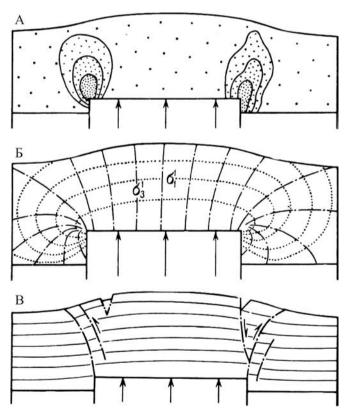
Рис. 3. Выполаживание крутых разрывных нарушений в приповерхностной части осадочного чехла: A — морфология и кинематика разрывов, образующихся в слоистом комплексе над боковыми гранями жесткого прямоугольного штампа [19]; B, B — распределение напряжений в слоистом комплексе над прямоугольным штампом [1]: B — распределение напряжений по величине, B — траектории главных сжимающих B0 и растягивающих B1 напряжений
