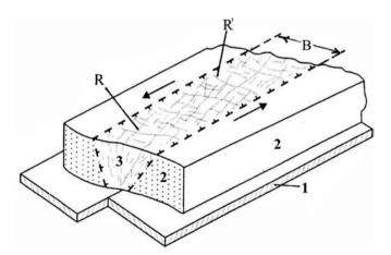
Рис. 1. Диагональные (R) и поперечные (R') ридели области динамического влияния разлома фундамента в осадочном чехле: 1 — фундамент; 2 — осадочный чехол; 3 — область динамического влияния разлома (ОДВР); 4 — ширина ОДВР на поверхности. Плановая ориентировка риделей по отношению к трассе разлома указывает на то, что он является левосторонним сдвигом
