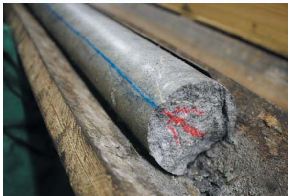
Рис. 2. Керн с нанесенными отметками ориентирования из скважины на месторождении Прогноз (Якутия)
