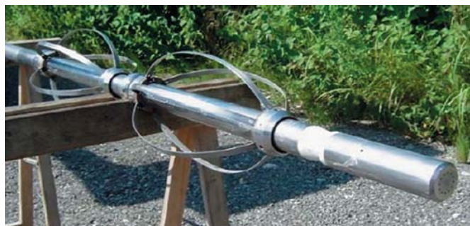
Рис. 4. Акустический зонд типа ALT QL40-ABI-2G
