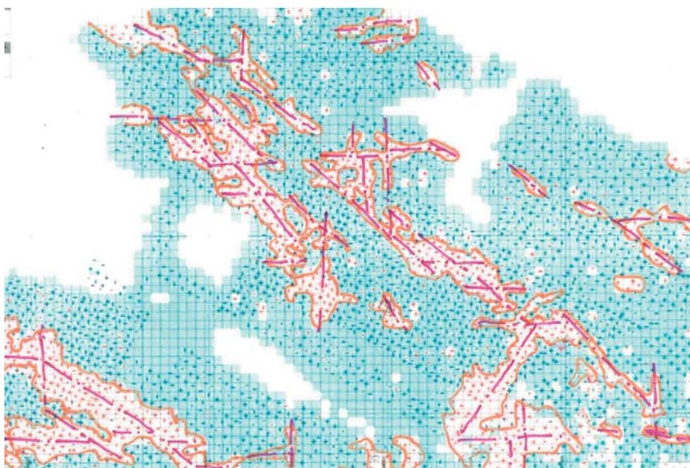
**Рис. 4.** Контуры рудных тел на фрагменте горизонта 764 м. Крестиками отмечено положение рудных (красное) и безрудных (синее) скважин БВР
