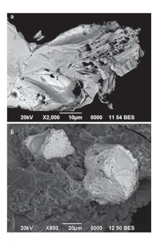
Рис. 6. Комковидное выделение электрума с участками слоисто-ступенчатой микроморфологии поверхности (а), кристаллы акантита сложного габитуса с коррозионной скульптурой граней (б). Электронно-микроскопические снимки. Зона Центральная Кундумийского месторождения, обр. 0056–13
