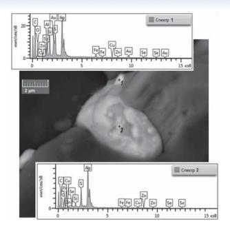
Рис. 5. Тонкие наросты кюстелита (каплевидная белая микрофаза, ЭДС-спектр 1) и селенистого акантита (бугристо-лепешковидная серая фаза, ЭДС-спектр 2) на пирите (темное зерно). Электронно-микроскопическое изображение в обратных электронах. Месторождение Авлаяканское, обр. А-1
