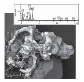
Рис. 4. Причудливой формы выделение акантита с «головкой» из смеси тонких фаз акантита-галенита. Электронно-микроскопическое выделение в обратных электронах и ЭДС спектр состава. Месторождение Авлаяканское, обр. А-1
