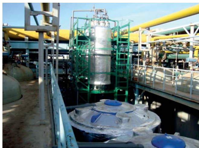
Рис. 4. Сорбционно-десорбционный модуль на предприятии «Lan Ke Lithium» (г. Гэрму, провинция Цинхай, КНР)
