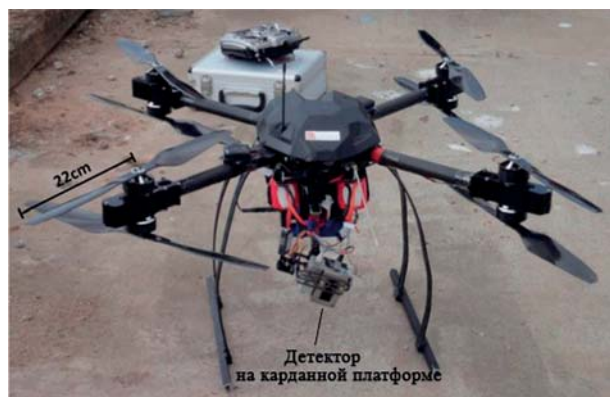
Рис. 1. Внешний вид автономного радиометрического БПЛА с детектором
