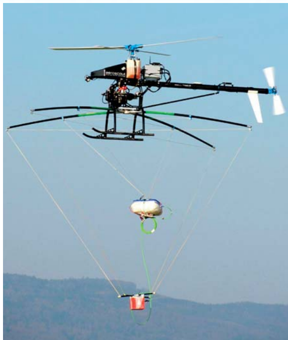
Рис. 2. БПЛА Aeroscout B1-100 с установленной на нем электромагнитной системой Metronix
